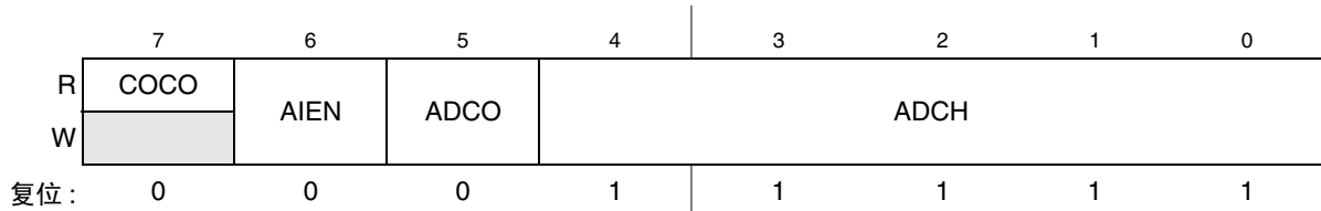
图 10-3. 状态和控制寄存器 (ADCSC1)
