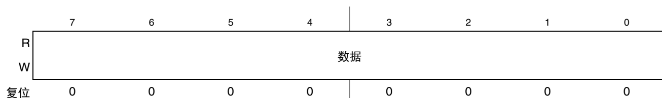
图 11-7. IIC 数据 I/O 寄存器 (IICD)
